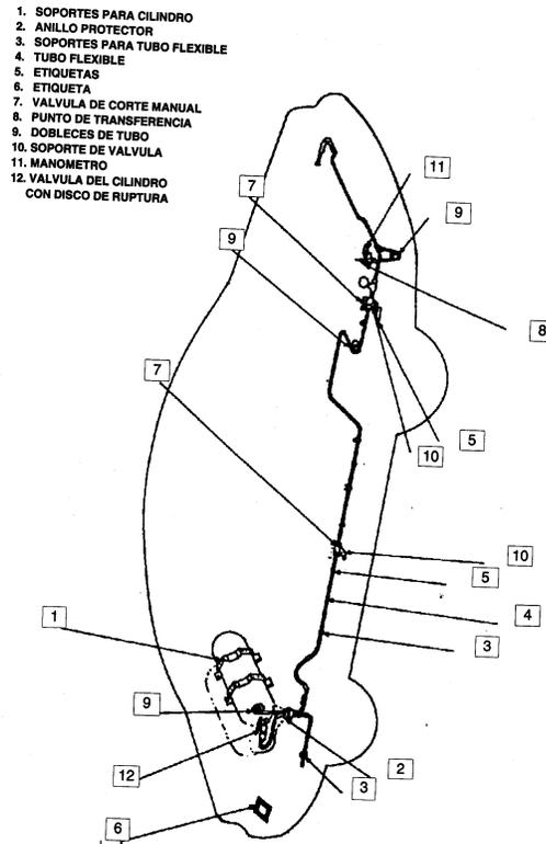
**Figura 17.-** Componentes para un sistema vehicular a GNC
