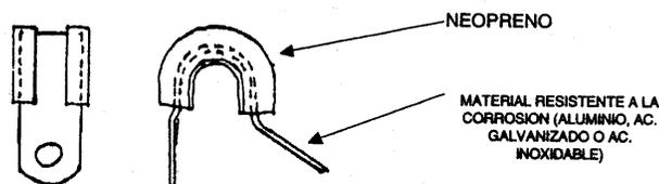
**Figura 9.-** Sujetador para línea de suministro
