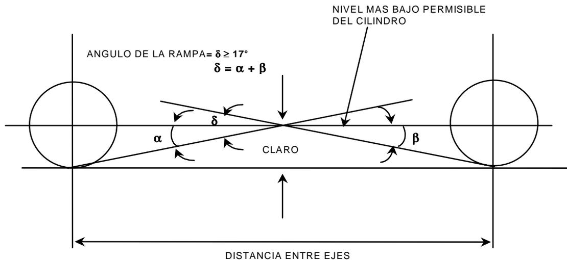
**Figura 2.-** Método para determinar el nivel más bajo permisible del cilindro de GNC
