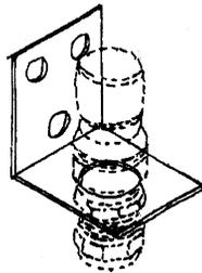
**Figura 12.-** Soporte de la boquilla de recepción
