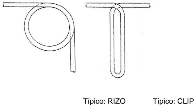
**Figura 1.-** Dobleces para evitar vibración y esfuerzos en la línea de alta presión
