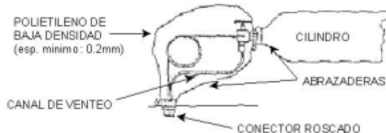
**Figura 7.-** Cubierta a prueba de fugas en compartimento cerrado
