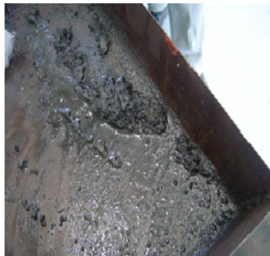
2 de Octubre de 2006. Al drenar la trampa colectora nuevamente, se observa, además de los líquidos referidos, un alto contenido de partículas sólidas.
